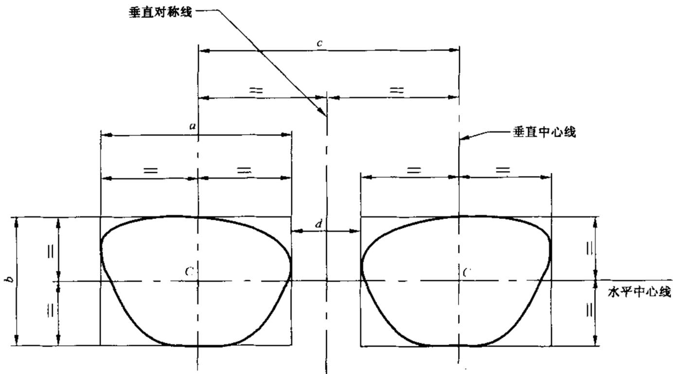
图 1 方框法测量示意图
