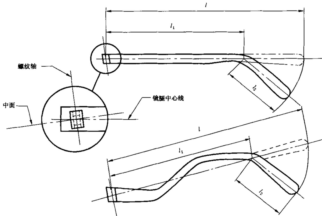
图 2 镜腿长度( $l=l_1+l_2$ )测量示意图
